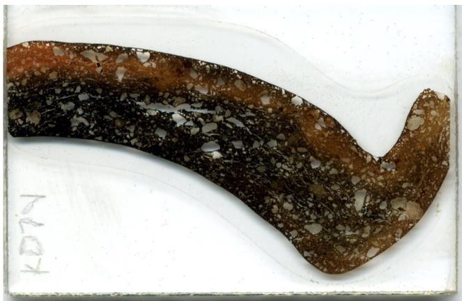
**Figure 5 :** Structure interne d'un fragment de céramique analysé.
